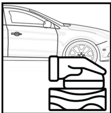
1. Después de una buena preparación del área de reparación, afine todo el panel con P1000-P1500 seco o P1500-P2000 húmedo para asegurar una buena adhesión y evitar marcas de abrasivo.
