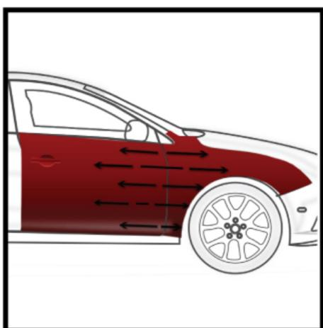
3. Raccorder la teinte de base en utilisant le raccordeur approprié si besoin selon FT.
