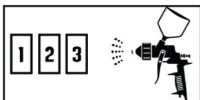
1. Appliquer le bon coloris d'apprêt comme indiqué dans le logiciel Genmix sur 3 plaquettes test et sécher correctement.
