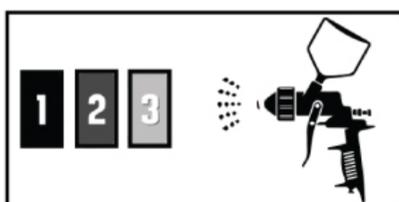
7. . Après séchage contrôler sur le véhicule laquelle des trois applications correspond à la teinte d'origine afin de déterminer le nombre de couches nécessaire de vernis teinté.
