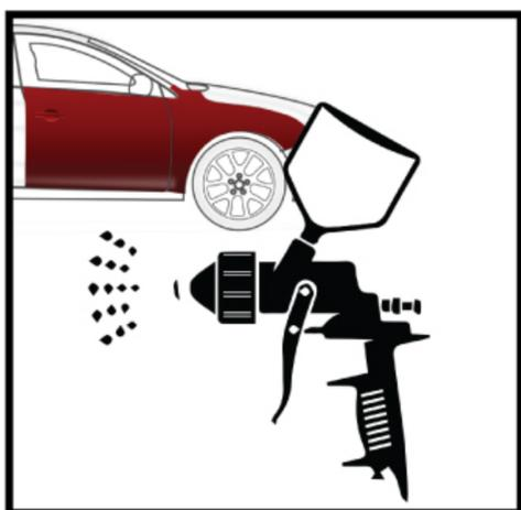
5. Aplicar verniz colorido 2K sobrepondo a área da camada base no número desejado de camadas, conforme definido pelo procedimento do painel descendente
