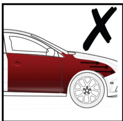
6. O verniz colorido 2K deve cobrir e se sobrepor à área de aplicação da superfície pintada anteriormente com a base de fundo. É essencial não revestir todo o painel reparado com verniz colorido 2K, especialmente a parte voltada para o painel adjacente, principalmente para evitar tonalidades mais escuras e, portanto, diferença de cor em relação ao painel adjacente.
