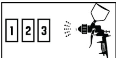
1. Aplique nas 3 chapas de teste o primário com a cor correcta, conforme o sistema GenMix, faça flash-off ou deixe seque adequadamente.
