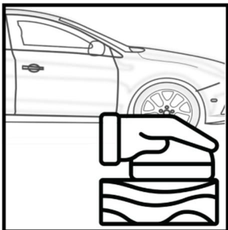
1. Após uma boa preparação da área de reparo, alise todo o painel com lixa a seco P1000-P1500 ou P1500-P2000 a molhado para garantir uma boa adesão e evitar arcos escuros.
