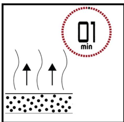
8. O flash-off é inferior a 1 minutos entre a camada de verniz colorido e o verniz (sem tinta), para dissolver o excesso de pulverização resultante nas áreas envolventes à da área de reparação.
