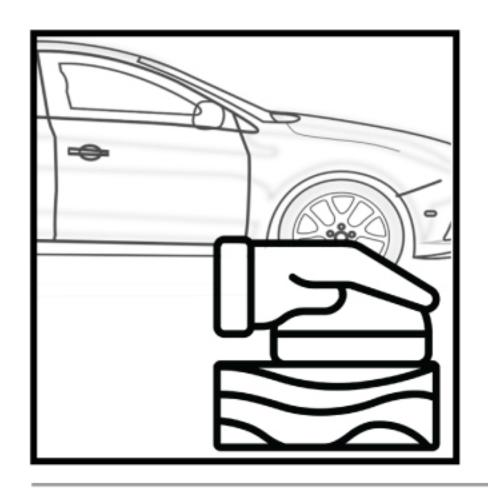
1. 1Después de una buena preparación del área de reparación, afine todo el panel con P1000-P1500 seco o P1500-P2000 húmedo para asegurar una buena adhesión y evitar marcas de abrasivo.
